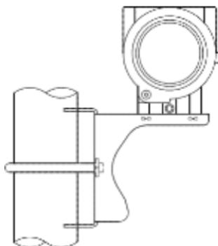
Рисунок 3.1.3 Установка углового кронштейна для монтажа на трубу-1
