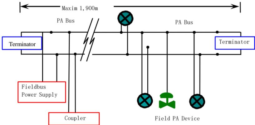
Рисунок 5.2 Подключение шины Profibus
