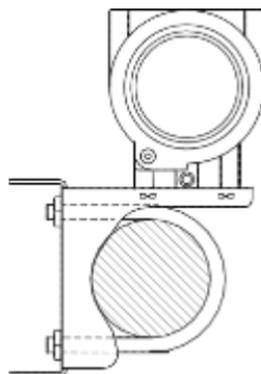
Рисунок 3.1.4 Установка углового кронштейна для монтажа на трубу-2
