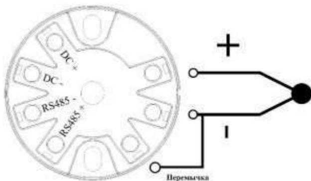
Рисунок 3.8.2. Подключение термопар к преобразователю NCS-ТТ106М
