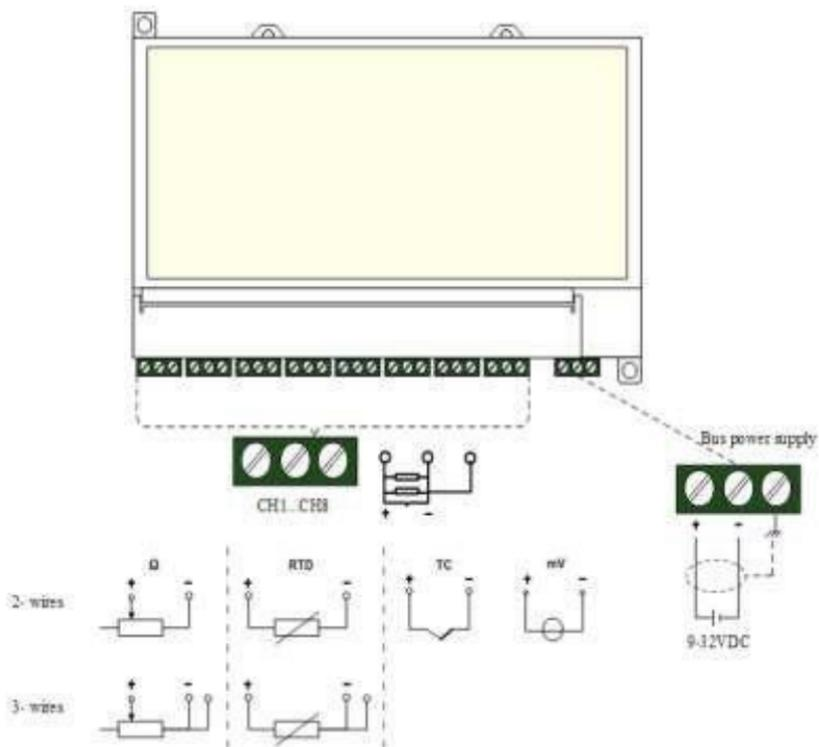
Рисунок 3.7. Подключение датчиков к преобразователю температуры NCS-TT108.
