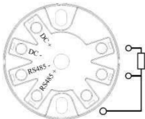
Рисунок 3.8.1. Подключение термометров сопротивления к преобразователю NCS-ТТ106М
