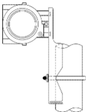
Рисунок 3.1.1 Установка плоского кронштейна для монтажа на трубу
