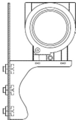
Рисунок 3.1.2 Установка углового кронштейна для крепления пластины
