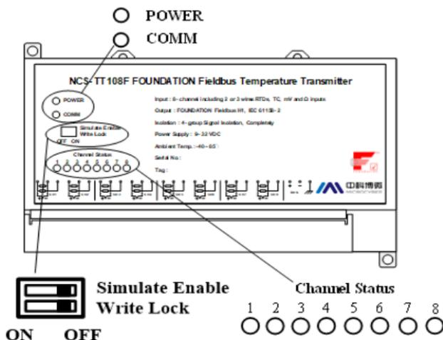
Рисунок 3.3.1 Внешний вид преобразователя NCS-TT108F
