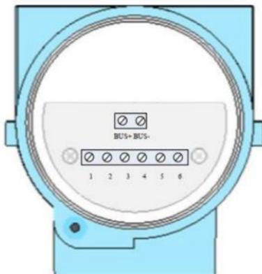
Рисунок 3.4.1 Клеммная колодка преобразователя температуры NCS-TT105
