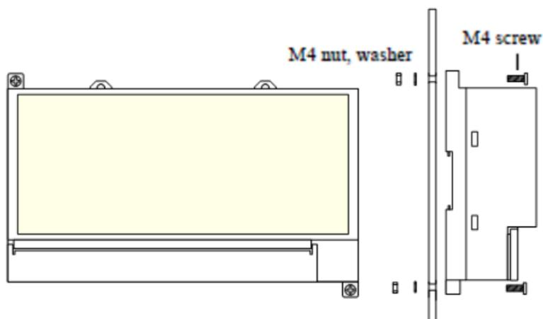
Рисунок 3.3.4 Установка NCS-TT108 с помощью винтов
