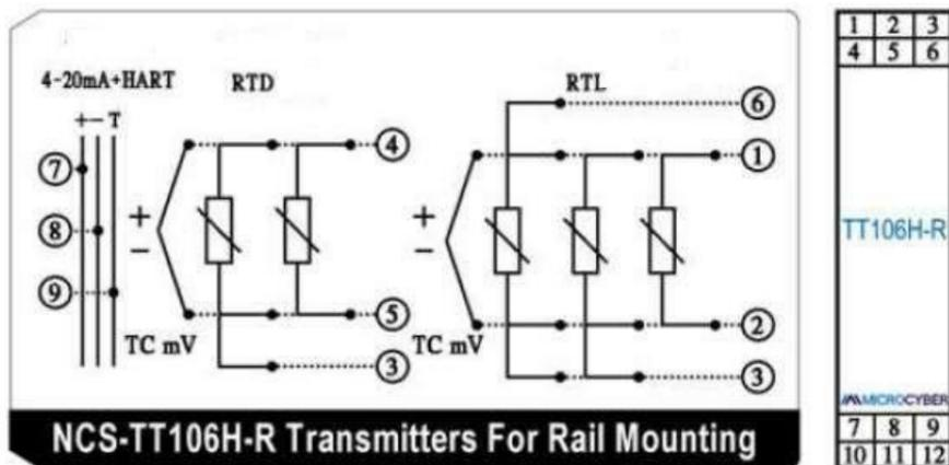
Рисунок 3.6. Подключение датчиков к преобразователю NCS-TT106H-R (1).
