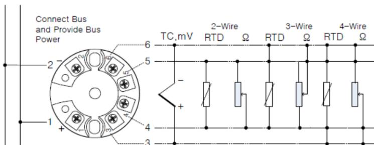
Рисунок 3.5 Подключение датчиков к преобразователю NCS-TT106
