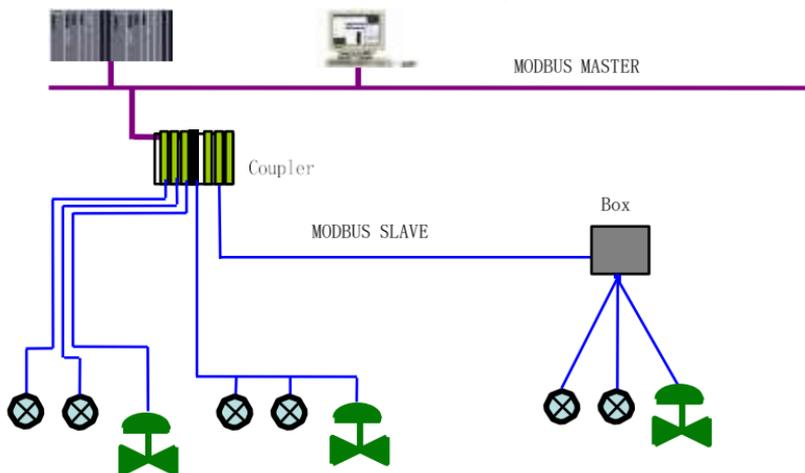
Рисунок 7.1 Топология сети Modbus
