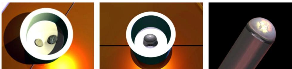
**Рис. 5. Сварка кабельной термопары**
